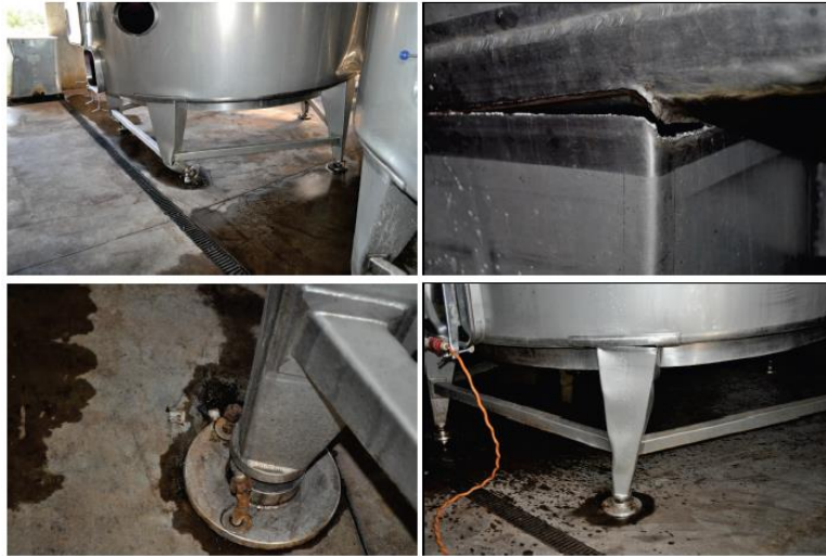
איור 4-6.4.2.1-4 – מיכלים ביקב שנפגעו ברעידת אדמה. ניתן לראות כשלים שונים: כשל בעיגון ברגים, כשל בקריסה של רגלי התמיכה, כשל בריתוכים. שימוש בברגים לפילוס גובה המיכלים גרם ליצירת אזור חלש בין תחתית הרגלים לרצפת חלל האחסון.
